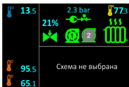
Рисунок 26 - Пример индикации режима «Независимая система отопления (1)»
