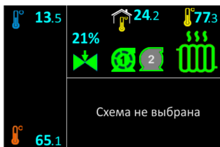
Рисунок 30 - Пример индикации режима «Независимое отопление (3)»
