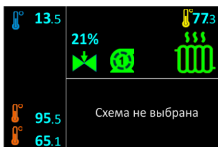
Рисунок 33 - Пример индикации режима - «Независимое отопление (4)»
