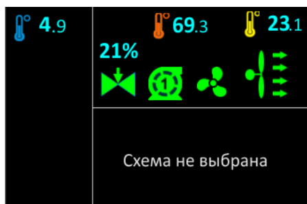
Рисунок 46 - Пример индикации режима «Вентиляция (9)»
