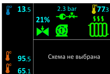
Рисунок 28 - Пример индикации «Независимое отопление (2)»
