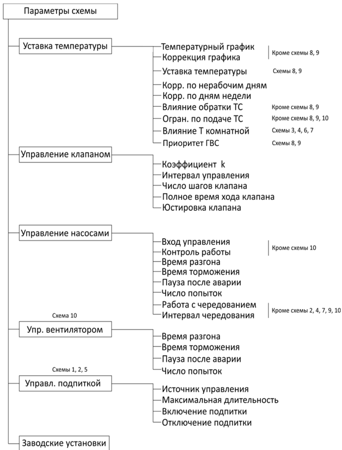
Рисунок 23 - Блок-схема пунктов меню «Параметры»
