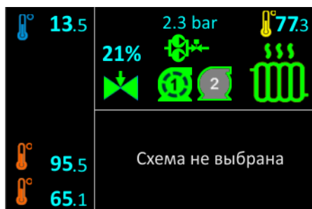
Рисунок 35 - Пример индикации «Независимое отопление (5)»
